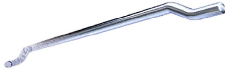
Fig. 1 Steel fiber (Nikolaisen 2010).
