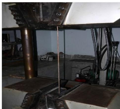
(b) Steel bar tensile test
