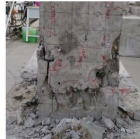
(d) The bottom of the column after failure
